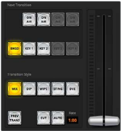
Contrôle des transitions
