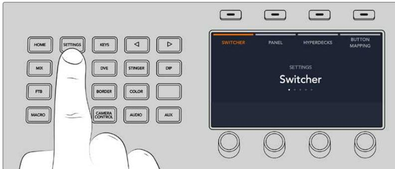
L'ATEM 1 M/E Advanced Panel affiche quatre options de configuration sur le haut de l'écran LCD. Ces options sont : **Mélangeur**, **Panneau**, **HyperDecks** et **Mappage des boutons**. Chacune de ces options correspond à un menu de configuration. Il suffit d'appuyer sur le bouton multifonction de l'écran LCD situé au-dessus du paramètre **HyperDecks** pour accéder au menu **Paramètres HyperDeck**.
