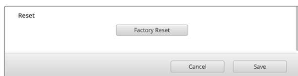
Appuyez sur le bouton Factory Reset pour restaurer l'ATEM Streaming Bridge sur DHCP afin qu'il puisse être détecté automatiquement sur votre réseau.
