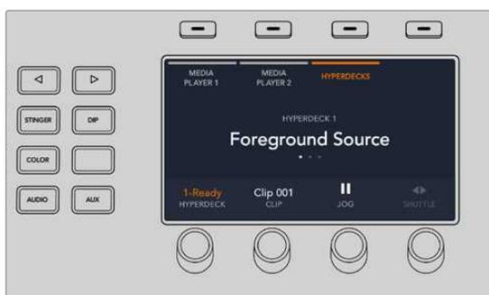
Utilisez ensuite les molettes situées sous les indicateurs **HyperDeck**, **Clip**, **Jog** et **Shuttle** pour sélectionner les HyperDecks et les clips, ainsi que pour faire défiler les clips.
