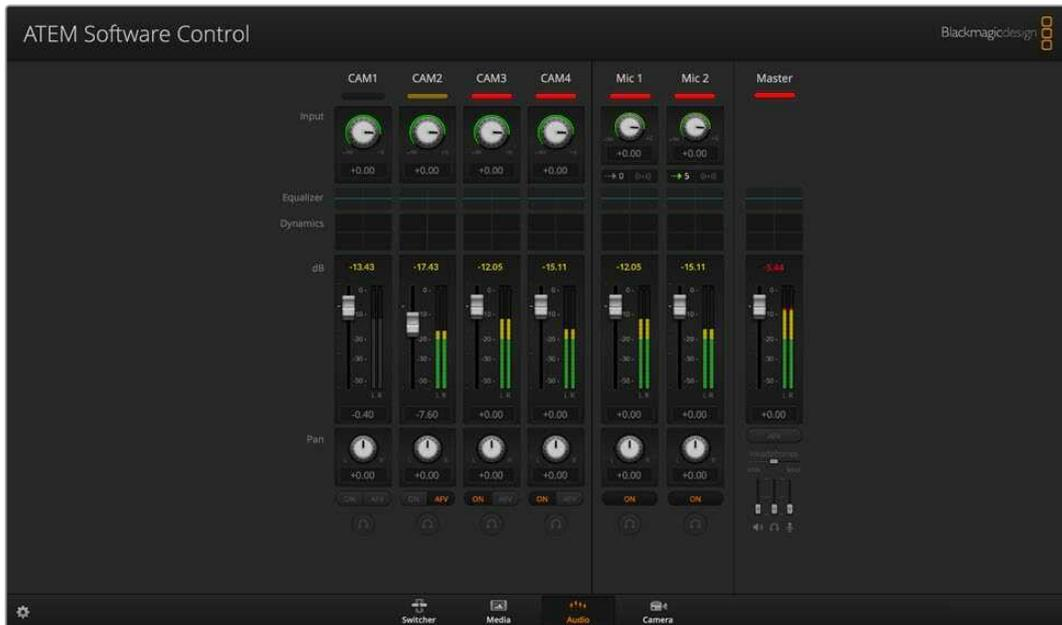
Le mixeur audio affiche des voyants tally pour toutes les sources audio qui sont actuellement à l'antenne ou lorsque la fonction AFV est sélectionnée. Il affiche également les niveaux audio, la balance audio et des boutons permettant de sélectionner l'audio qui doit être utilisé.
