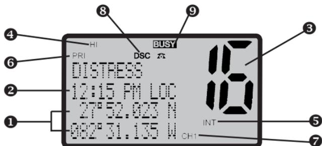
La latitude et longitude ❶ du vaisseau et l'heure locale ❷ sont illustrées ici. Une transmission sur le canal 16 ❸ est effectuée à une puissance élevée ❹. La bande internationale de canaux ❺ est chargée. Le canal 16 est défini en tant que canal prioritaire ❻. Le canal 16 est également configuré en tant que canal favori ❶. La fonctionnalité DSC (ASC) ❸ est activée. Il y a un appel DSC entrant ❸ par conséquent le récepteur est occupé ❹.
